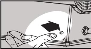
4. Después de haber encendido la llama mantener pulsado el botón del gas durante 15 segundos para activar los dispositivos térmicos de seguridad.
