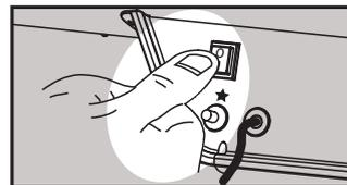
2. Käynnistä ventilaattori painamalla valkoista kytkintä.
