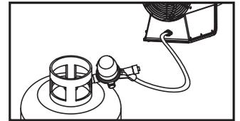
De gasinvoerdruk wordt aangegeven door de standaard bijgeleverde drukregelaar die voldoet aan de specificaties in de tabel technische gegevens.
