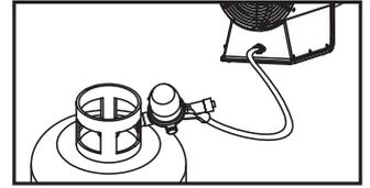
Saantipaineen takaa paineensäädin, joka toimitetaan perusvarusteena ja vastaa tekniset tiedot taulukon tietoja.
