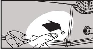
4. Etter tenning av flammen, hold inne gassknappen i 15 sekunder for å aktivere sikkerhetsanlegget.
