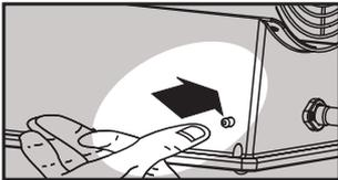
4. Nach Zündung der Flamme den Gasdruckknopf ca. 15 Sekunden gedrückt halten, um die thermischen Sicherheitsvorrichtungen zu aktivieren.
