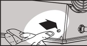
4. Als de vlam aan is, de gasknop gedurende 15 seconden ingedrukt houden om de veiligheidsfuncties te activeren.
