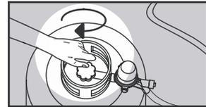
• Draai de gasfles dicht.
