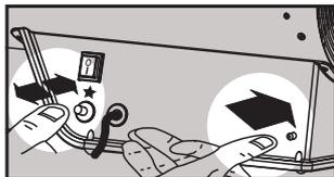
3.Appuyer à fond sur le bouton du gaz, et tout en le tenant appuyé, actionner plusieurs fois sur l'allumeur piézoélectrique.
