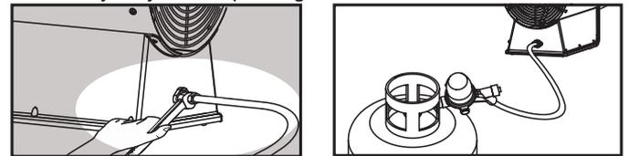
Det går att ansluta flera behållare för större oberoende. Matartrycket regleras med hjälp av ett tryckreglage som levereras som standard parti och skall vara fast inställt på det värde som anges i tabellen tekniska data.
