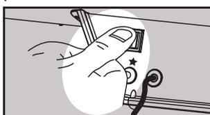
• Mettre l'interrupteur en position 0.
