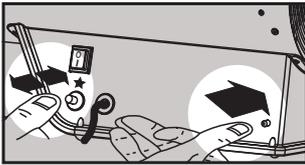
3. Pressionar o botão-gás até o fundo, e mantendo-o pressionado, acionar repetidamente o acendedor piezelétrico.
