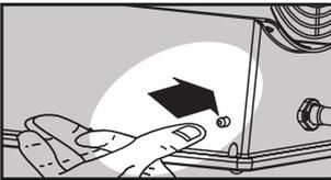
4. Efter at flammen er tændt, skal man fortsætte at holde gasknappen nede i 15 sekunder for at aktivere sikkerhedsanordningerne.
