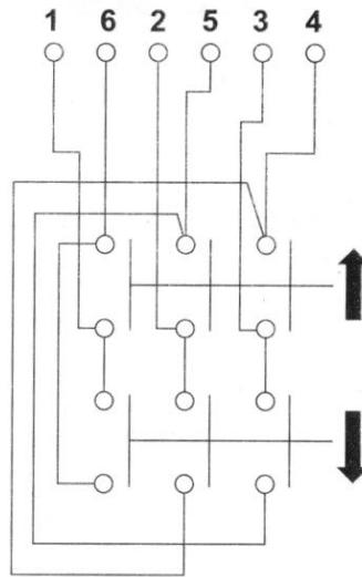
Электрическая схема лебедок серии KDJ-200E/250E/300E с питанием 220 В.
